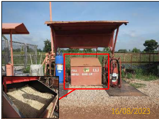
ภาพที่ 2.1-33 อุปกรณ์จัดครบน้ำมัน
