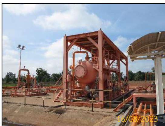
ภาพที่ 2.1-6 เครื่องแยกสถานะ (Production Separator)
