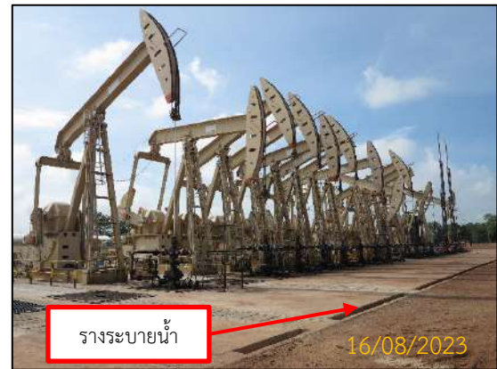
ภาพที่ 2.1-11 การจัดวางและติดตั้งอุปกรณ์การผลิตบนพื้นคอนกรีตที่มีรางระบายน้ำล้อมรอบ
