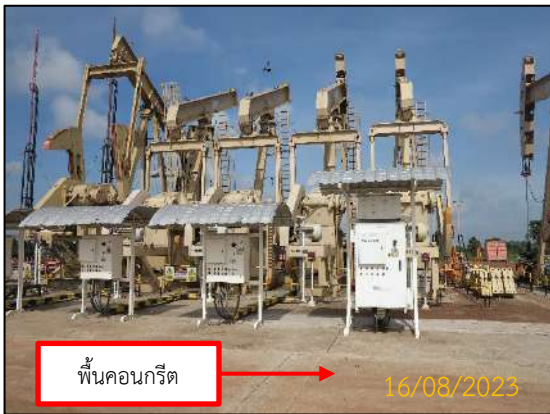
ภาพที่ 2.1-11 การจัดวางและติดตั้งอุปกรณ์การผลิตบนพื้นคอนกรีตที่มีรางระบายน้ำล้อมรอบ
